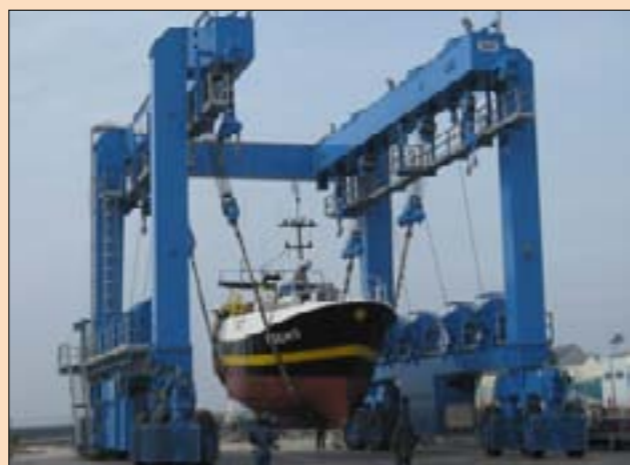
Le nouvel élévateur de 350 tonnes du Guilvinec est opérationnel depuis 2010.
